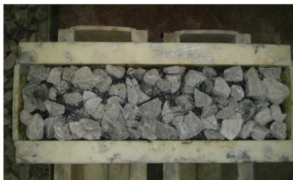
Figura 1.2 – Concreto em dois estágios reforçado com fibras de aço antes do lançamento do *grout*. (NEHDI, *et al.*, 2017).
