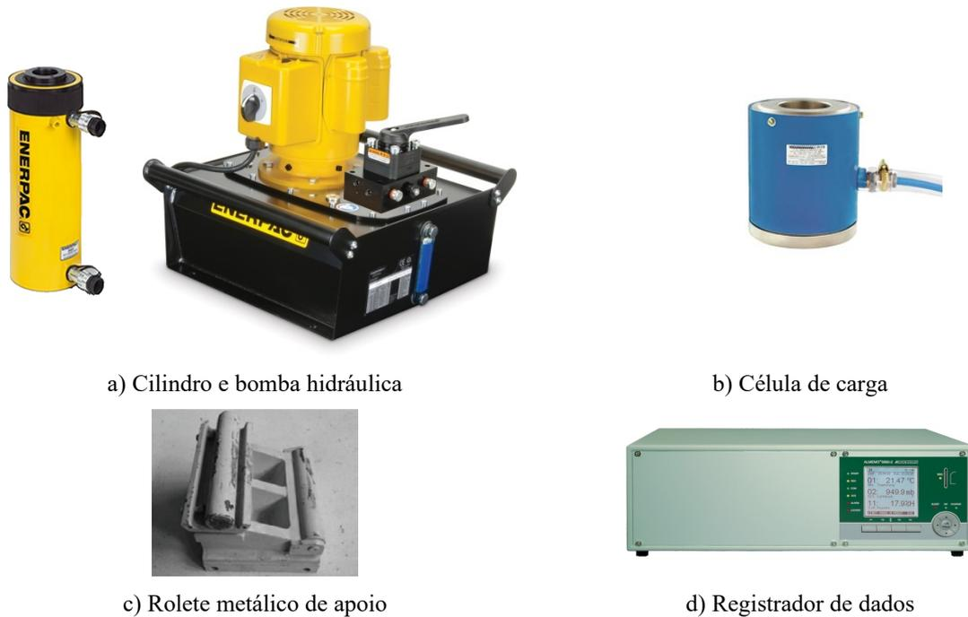
Figura 6.5 – Elementos do sistema de ensaio.
