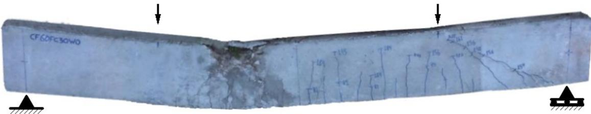
Figura 7.4 – Viga CF60W0 (ruptura em flexão pura).
