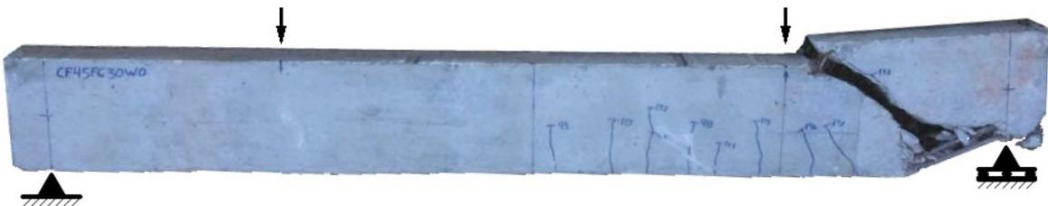
Figura 7.3 – Viga CF45W0 (ruptura por cisalhamento).
