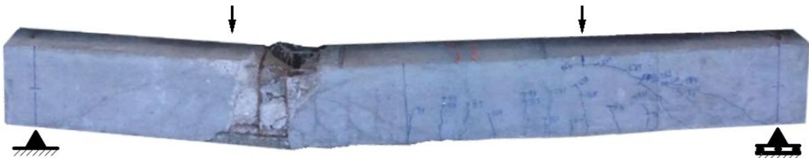
Figura 7.2 – Viga CF0W13 (ruptura em flexão pura).
