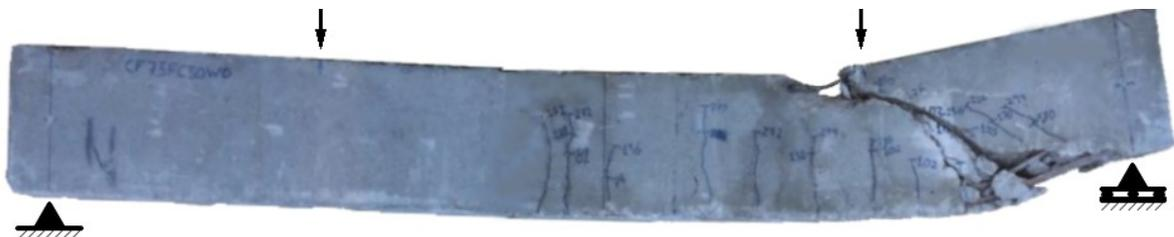
Figura 7.5 – Viga CF75W0 (ruptura em flexão pura).
