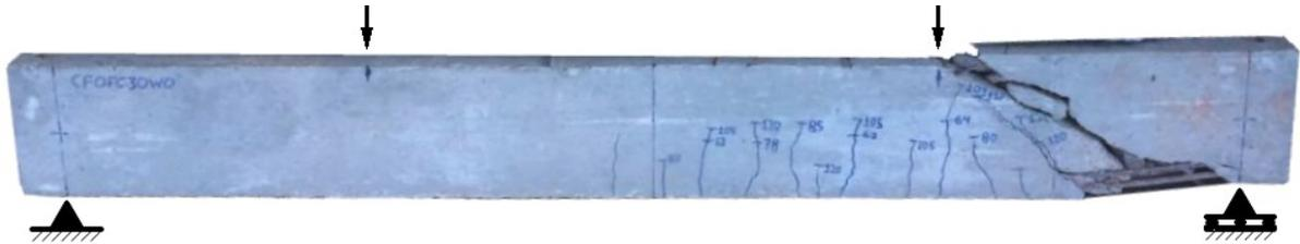
Figura 7.1 – Viga CF0W0 (ruptura por cisalhamento).
